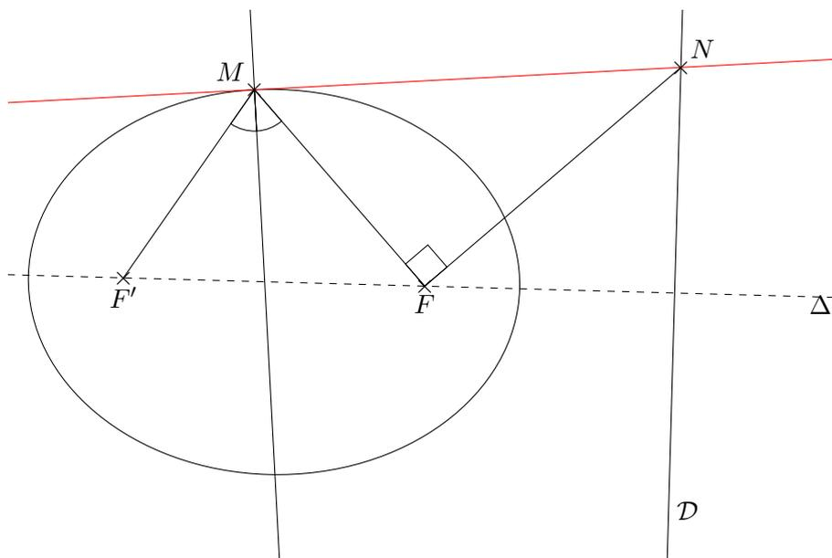
Ce phénomène de passage par les deux foyers a de nombreuses applications, par exemple : conversation discrète dans une salle ellipsoïdale, dialogue de part et d'autre du quai d'une station de métro à Paris. On obtient un résultat similaire pour l'hyperbole.
