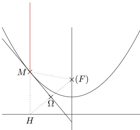
Soit  $\alpha$  l'angle que possède le rayon entrant avec la tangente. Puisque le rayon arrive parallèlement à l'axe focal, son prolongement passe par  $H$  donc  $\widehat{HM\Omega} = \alpha$ . Par le théorème on a également  $\widehat{FM\Omega} = \alpha$  donc on déduit que le rayon ressort selon  $(FM)$  donc passe par  $F$ .  $\square$
